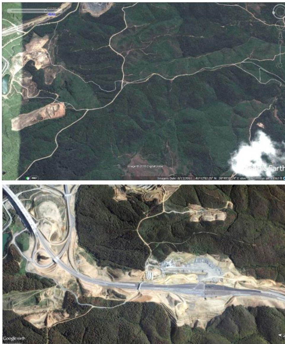
Figura nr. 6-20 Zone de pierdere și alterare a habitatului în urma construcției unei autostrăzi (sus - înainte; jos - după) (Nistorescu et al., 2016)
